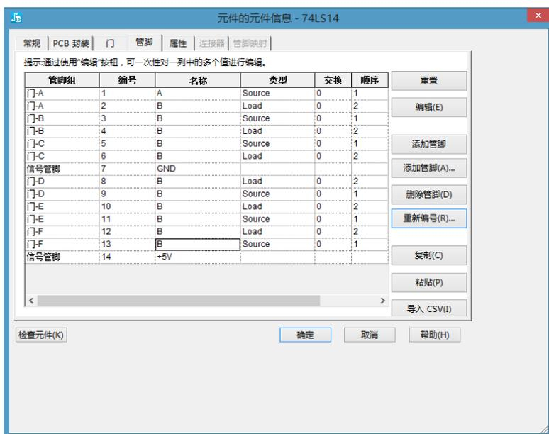
图 5-45 设置电源信号管脚
