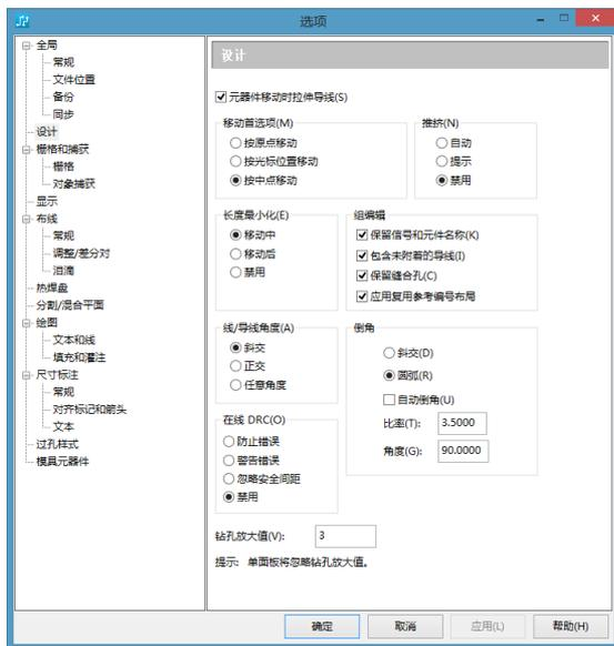
图 11-8 走线方向的设置
